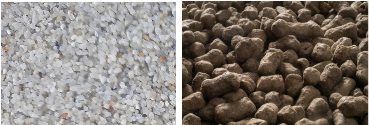
Figuur 5. Omstortingsmaterialen: omstortingsgrind (links) en zwelklei (rechts).
